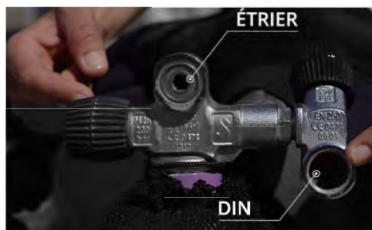
Figure 25 - Différence de robinetterie entre DIN et Etrier (avec opercule) - photo UCPA
